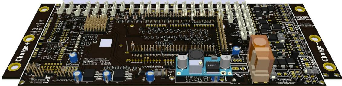
Setzt vor dem Löten das Arduino-Board auf. So stellt ihr sicher, dass alle Leisten ausgerichtet sind und später lässt sich das Board leichter auf und wieder abziehen.
