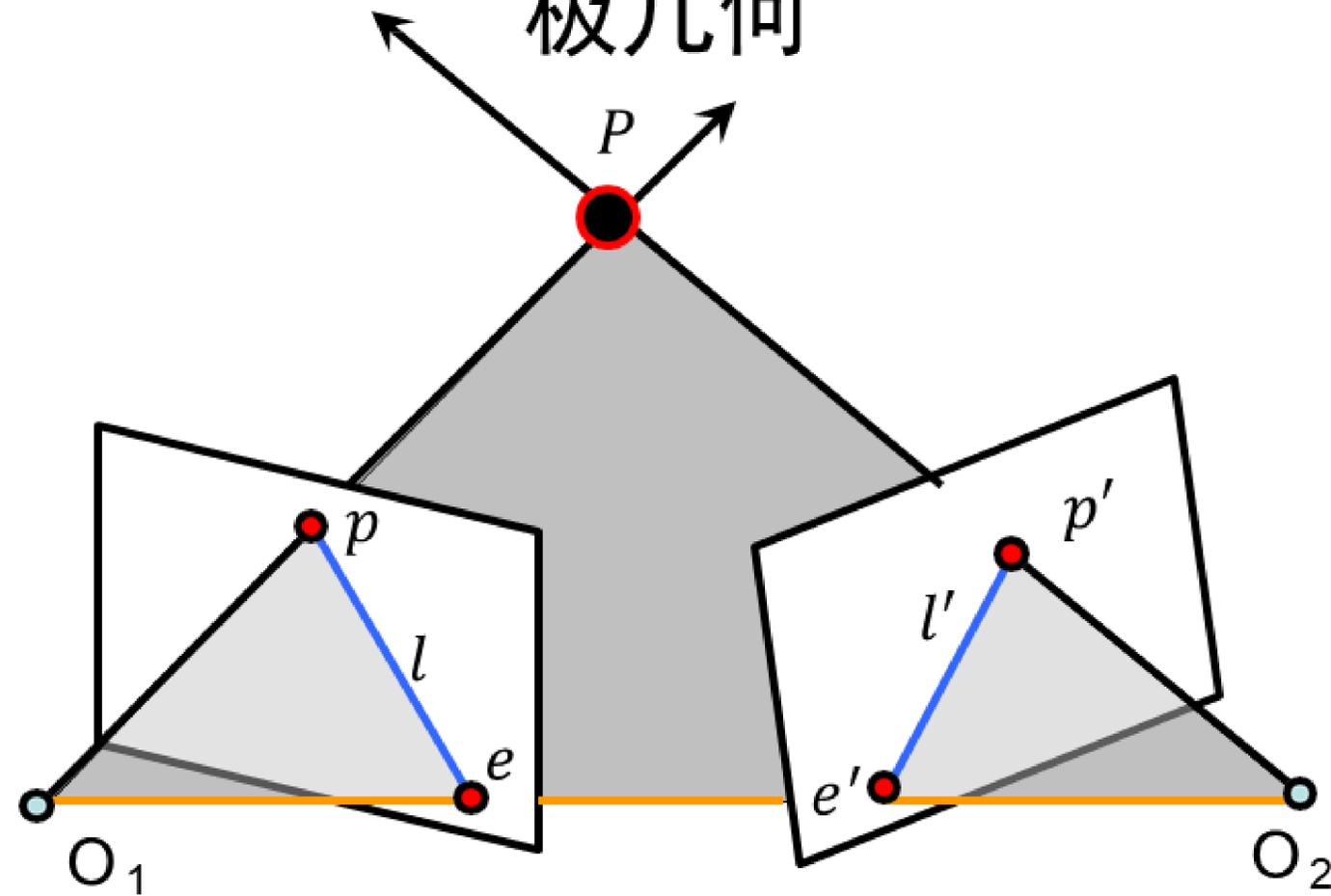
极平面：过点 $P$ ， $O_1$ 与 $O_2$ 的平面
