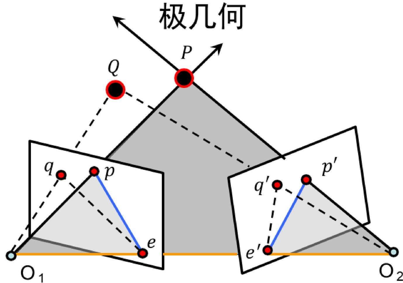
极平面：过点 $P$ ， $O_1$ 与 $O_2$ 的平面
