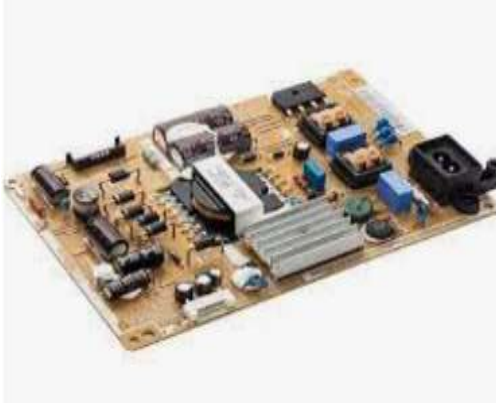
그림 4-1. 동사 SMPS(파워보드+LED드라이버 일체형)
