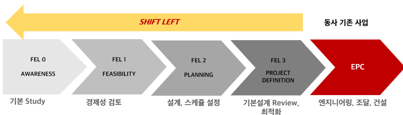
그림 2-18. 플랜트 사업의 전개과정, FEL(Feed, 기초설계) to EPC
