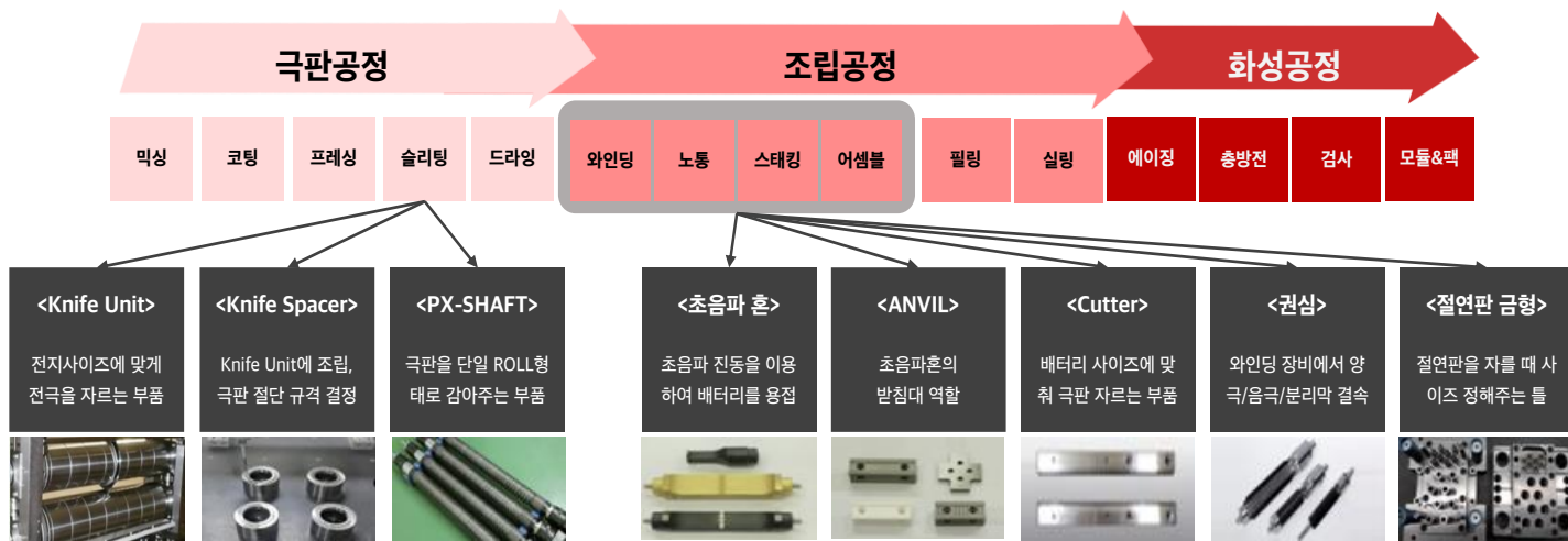
그림 6-1. 2차전지 공정 단계 및 동사 제품 적용 영역
