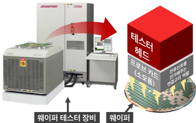
도표 2-1. 웨이퍼 테스트 반도체 칩의 양품 및 불량품 선별 과정
