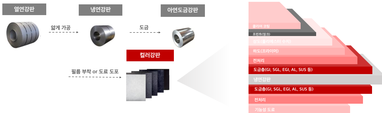
그림 3-3. 컬러강판 도장 과정 및 단면 예시
