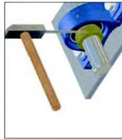
4. Bloquer l'excentrique de blocage en utilisant un poinçon et un marteau.
