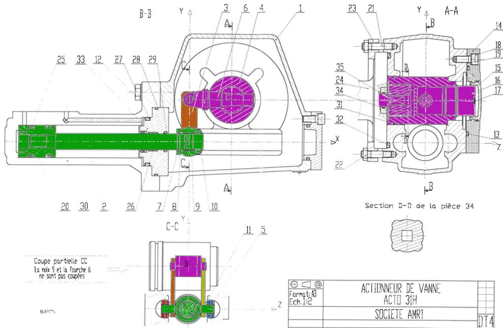
Question 14 : Le mouvement est assuré par un vérin il s'agit donc d'énergie hydraulique (pneumatique peut être acceptée même si elle ne peut pas fournir assez d'efforts).
