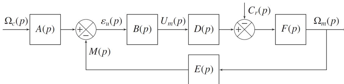
Figure 5 – Schéma-blocs de l'asservissement de vitesse du moteur
