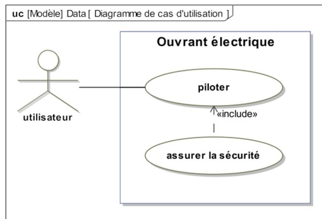
Figure 2 – Diagramme de cas d'utilisation d'un ouvrant électrique
