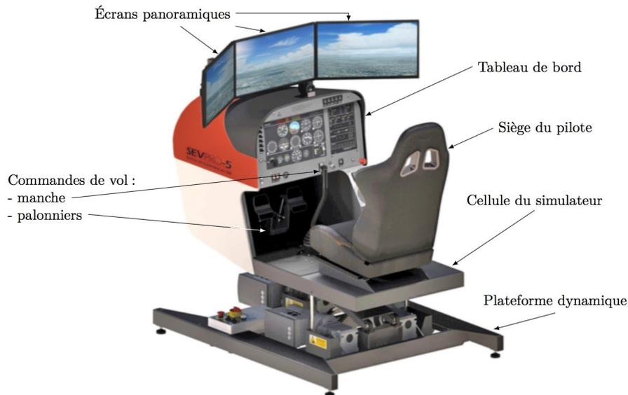
Figure 1 – Simulateur de vol à plateforme dynamique
