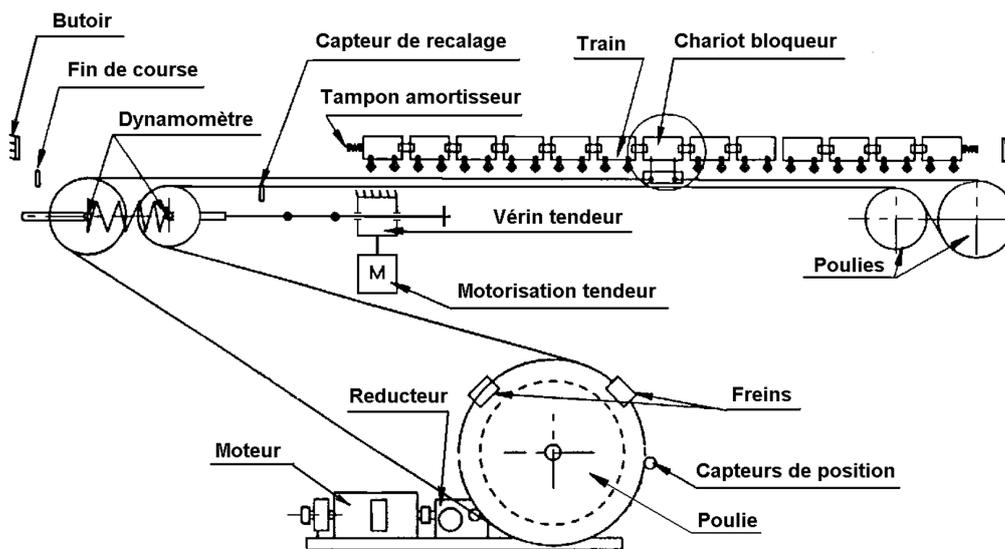
Figure 9 – Système de transport de bouteilles
