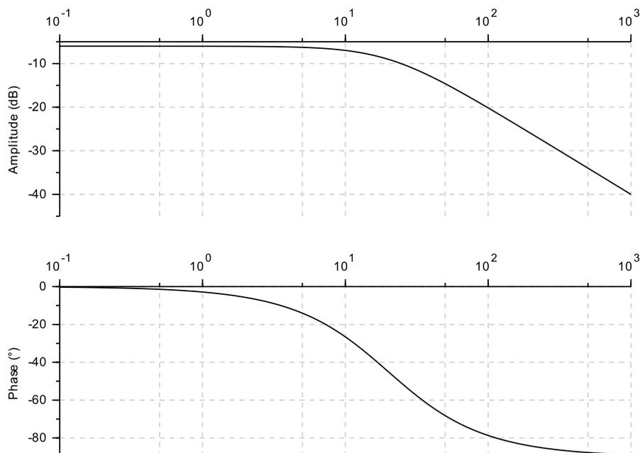
Figure 5 – Diagrammes de Bode du moteur
