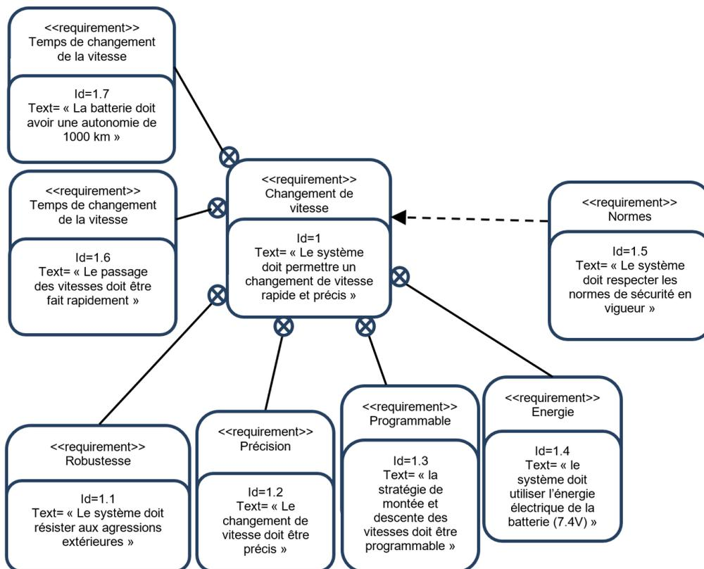
Figure 2 – Diagramme des exigences du dérailleur arrière
