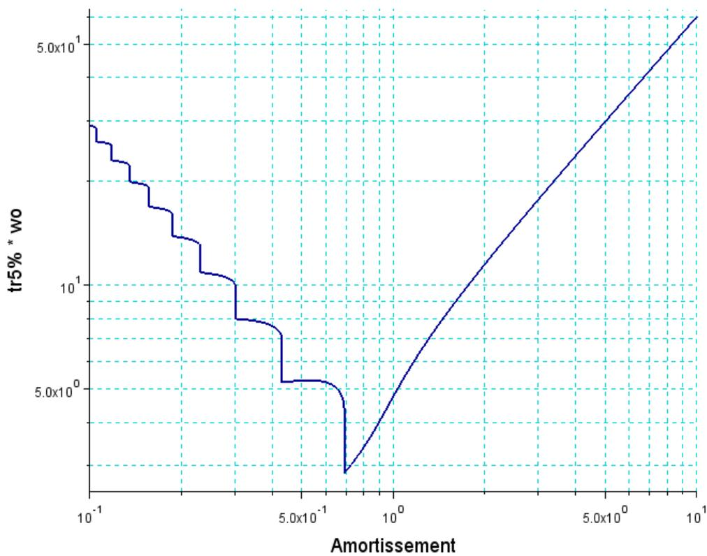
Temps de réponse réduit ( $t_{r5\%} * \omega_0$ ) en fonction de l'amortissement  $\xi$
