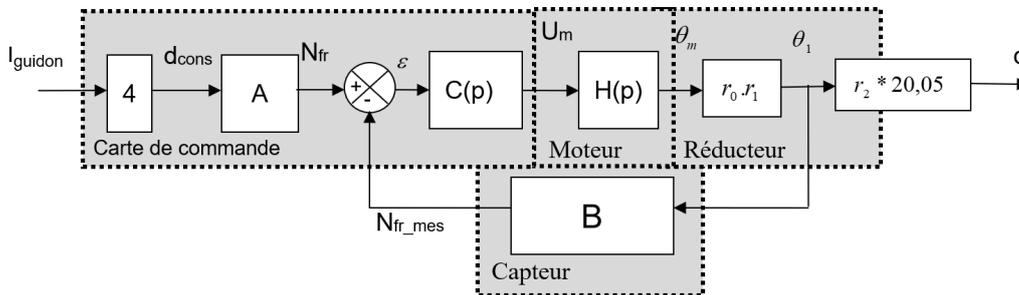
Figure 8 – Schéma bloc du dérailleur arrière
