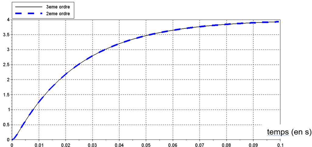
Figure 9 – Influence du 3<sup>ème</sup> ordre : déplacement de la patte de dérailleur (mm) en fonction du temps (s)
