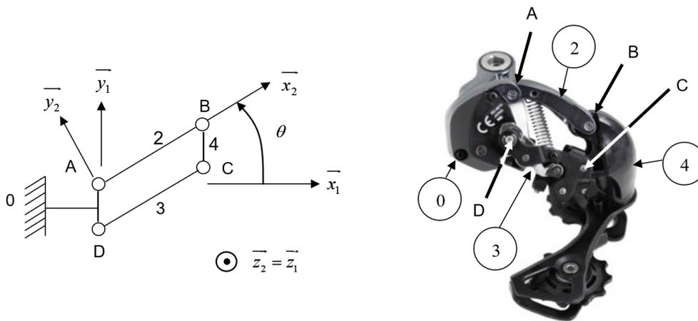
Figure 4 – Modélisation du dérailleur dans le plan  $(\vec{x}_1, \vec{y}_1)$
