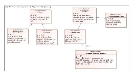
Figure 3 – Diagramme d'exigences du système
