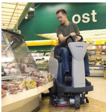
Figure 2 – Technicien sur une laveuse autoportée
