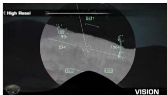
Figure 2 – Vision nocturne et affichage des informations de vol
