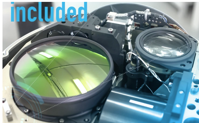
Figure 9 – Intérieur du FLIR, vue des optiques des caméras liées à l'étage fin d'élévation
