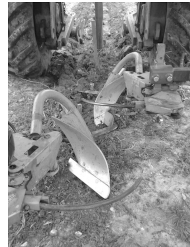
Figure 2 – Lames décavaillonneuses interceps équipant un enjambeur
