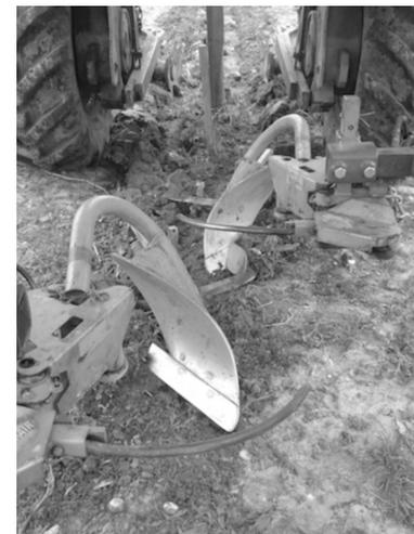
Figure 2 – Lames décavaillonneuses interceps équipant un enjambeur
