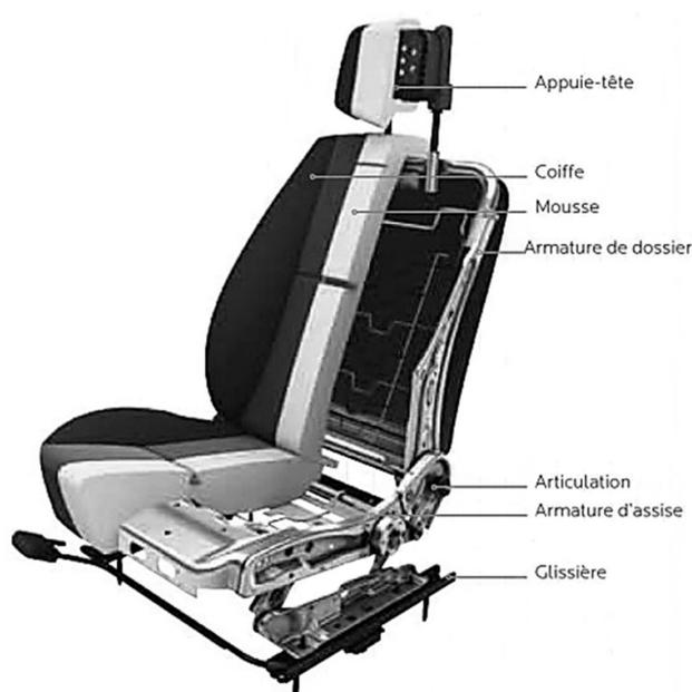
Figure 2 – Composition d'un siège automobile
