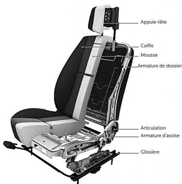
Figure 2 – Composition d'un siège automobile
