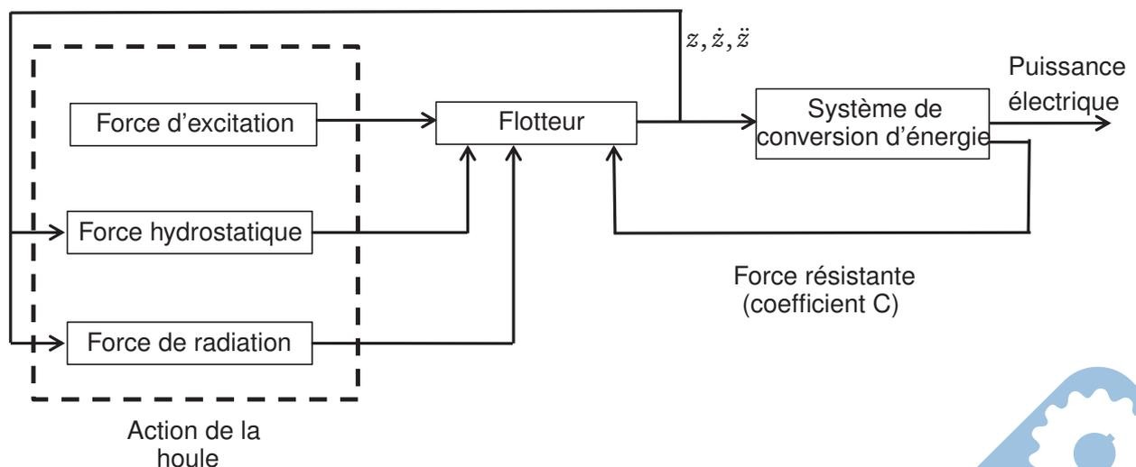
Figure 8 – Modèle multiphysique
