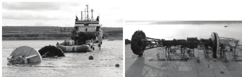
Figure 3 – Configuration horizontale pour maintenance et transport
