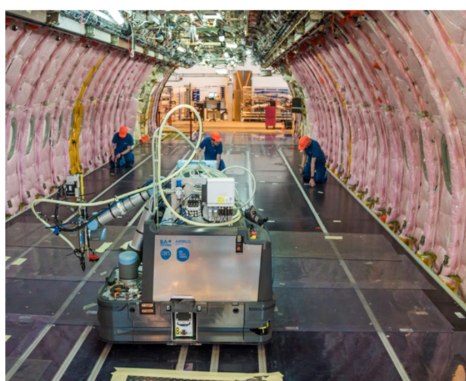
Figure 2 – Base TC200 dans l'application de vissage étudiée
