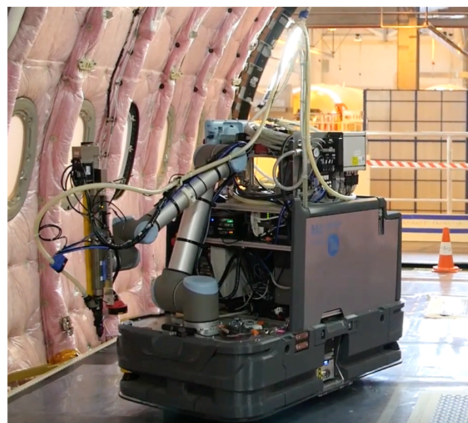
Figure 2 – Base TC200 dans l'application de vissage étudiée
