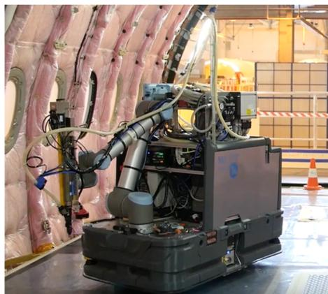
Figure 2 – Base TC200 dans l'application de vissage étudiée
