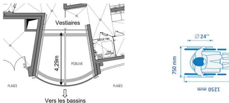
Figure 2 – Dimensions pédiluve et gabarit fauteuil roulant
