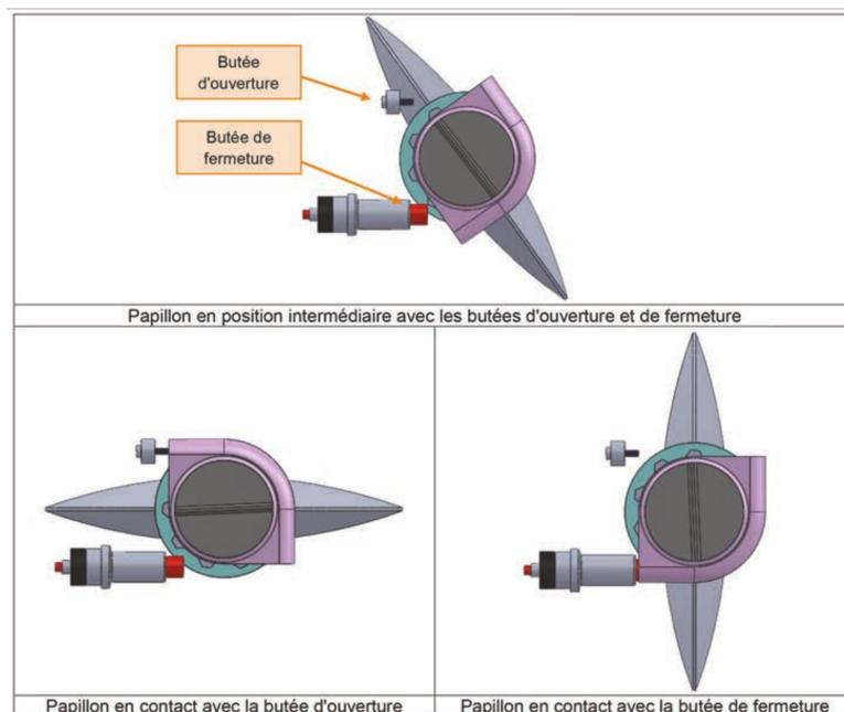
Figure 10 – Butées d'ouverture et de fermeture
