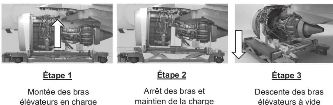
Figure 5 – Étapes pour la pose d'un moteur
