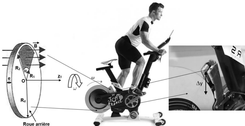
FIGURE 11 – Mesure et modélisation du couple de pédalage
