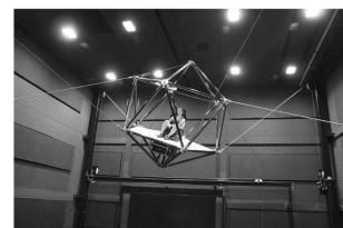
Simulateur de vol à six degrés de liberté et huit câbles répartis – Max Planck Institute for Biological Cybernetics (Allemagne)
