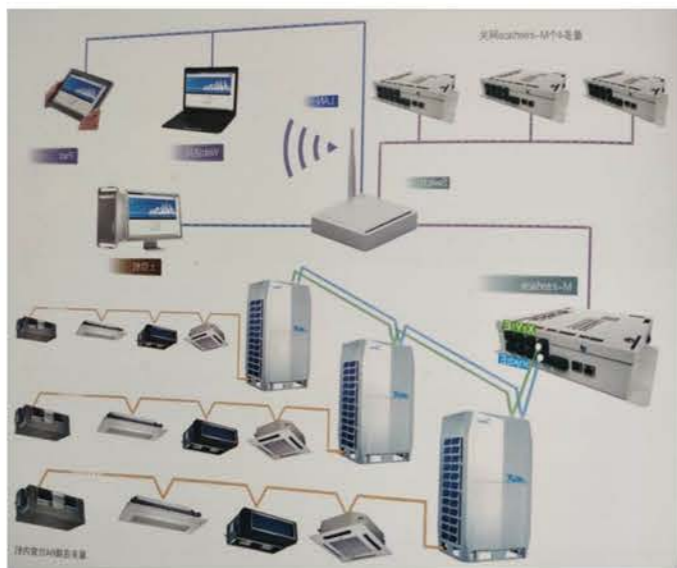
多联机系统原理图
