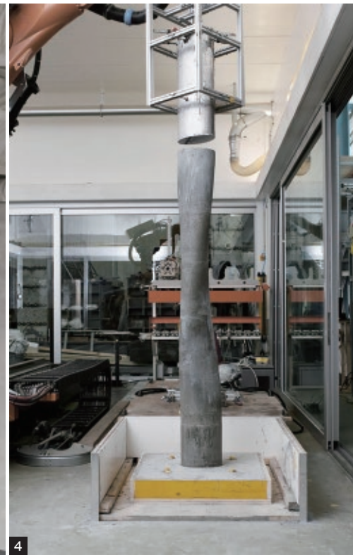
4 智慧動態水泥灌注施工過程
