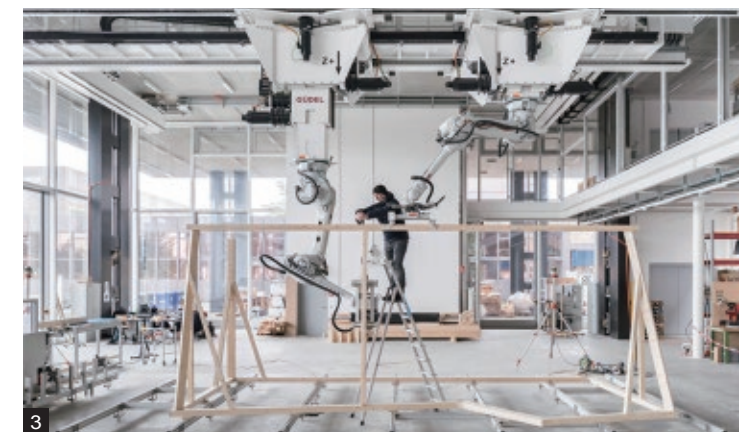
3 研究員協同機械手臂組裝DFAB House木結構過程照
