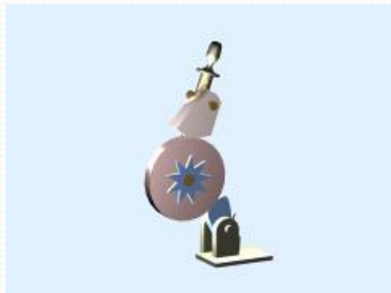
摩擦式棘轮机构
