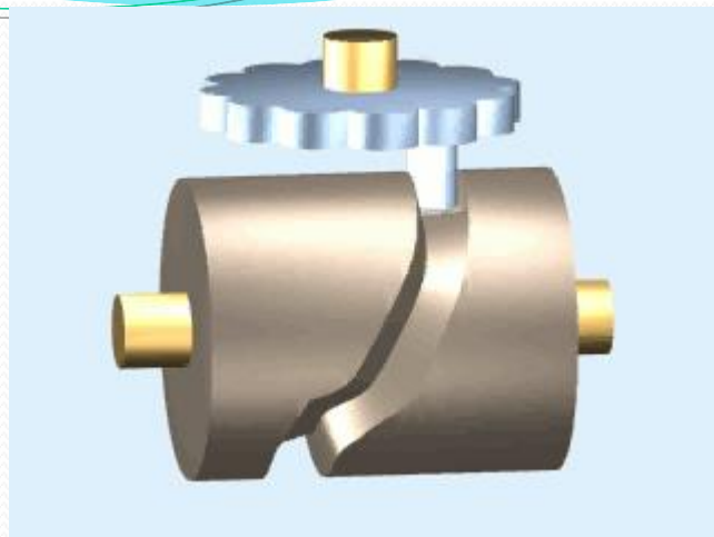
圆柱凸轮式间歇运动机构
