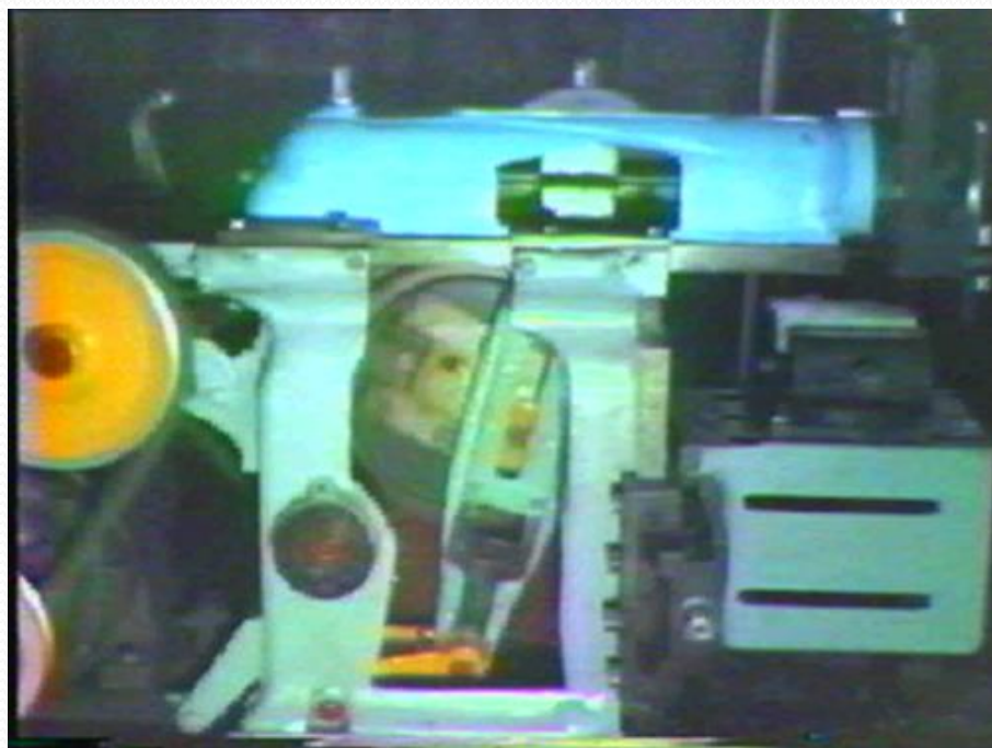
牛头刨床工作台的进给机构
