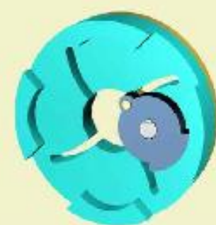
曲线槽内槽轮机构
