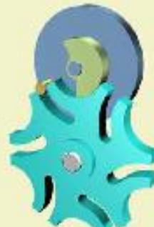
曲线槽外槽轮机构
