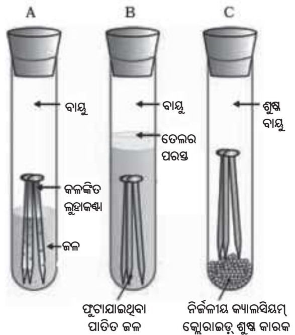
ଚିତ୍ର 3.13 କେଉଁ ପରିସ୍ଥିତିରେ ଲୁହାରେ କଳଙ୍କି ଲାଗେ ତାହାର ଅନୁଧ୍ୟାନ । A ପରୀକ୍ଷାନଳୀରେ ବାୟୁ ଏବଂ ଜଳ ଅଛି । B ପରୀକ୍ଷାନଳୀରେ ବାୟୁ ଜଳରେ ଦ୍ରବଣୀୟ ନୁହେଁ । C ପରୀକ୍ଷାନଳୀରେ ବାୟୁ ଶୁଷ୍କ ଅଟେ ।
