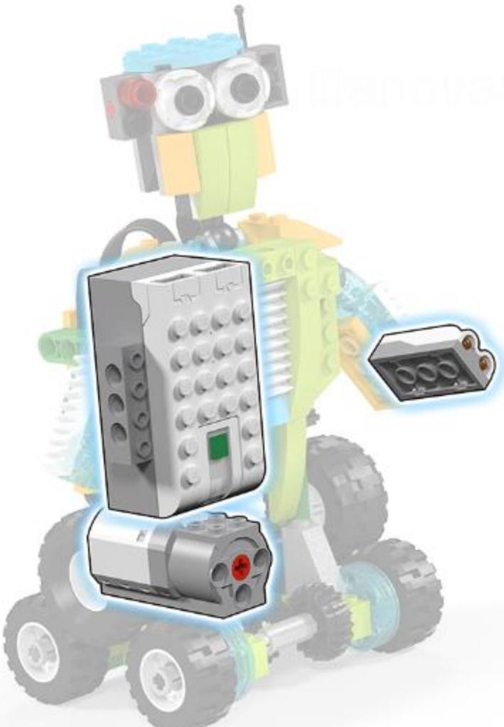
Smarty использует мотор для движения. Также робот дополнительно оснащен датчиком движения. Сенсор закреплен на руке.
