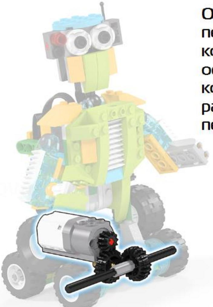
От мотора вращение передается через комбинированные шестерни к оси, на которой закреплены колеса. При этом сначала работает прямая зубчатая передача, а затем - угловая.
