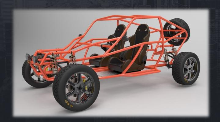
С автомобиля снимались кузов, двери и крылья, в качестве несущей структуры устанавливалась облегчённая рама или стекловолоконный кузов, или оставлялась урезанная версия штатного кузова.
