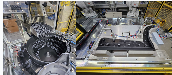
트림 및 가니쉬 화스너 조립 자동화
