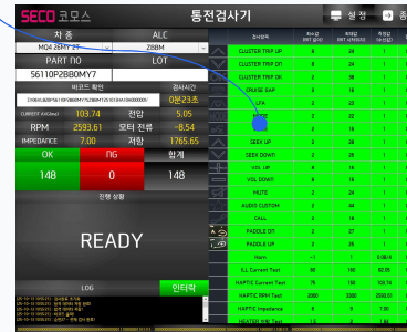
작업자 중심의 직관적 UI 기반 통전 검사 시스템 구현
