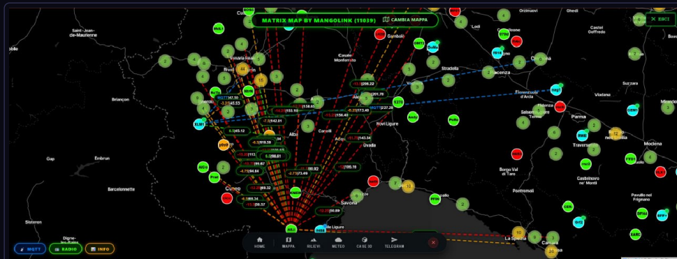
Rete Meshtastic nel Nord Italia — Linee verdi: collegamenti radio RF diretti. Linee blu tratteggiate: collegamenti MQTT via internet. Linee arancioni: collegamenti con SNR basso (segnale debole).
