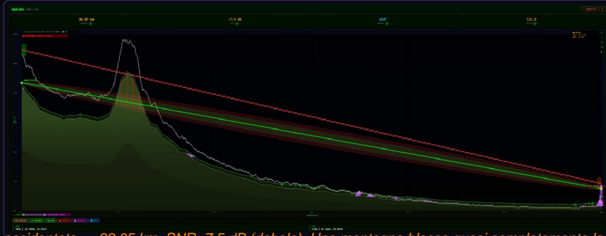
Link su terreno accidentato — 38.05 km, SNR -7.5 dB (debole). Una montagna blocca quasi completamente la zona Fresnel nei primi km.
