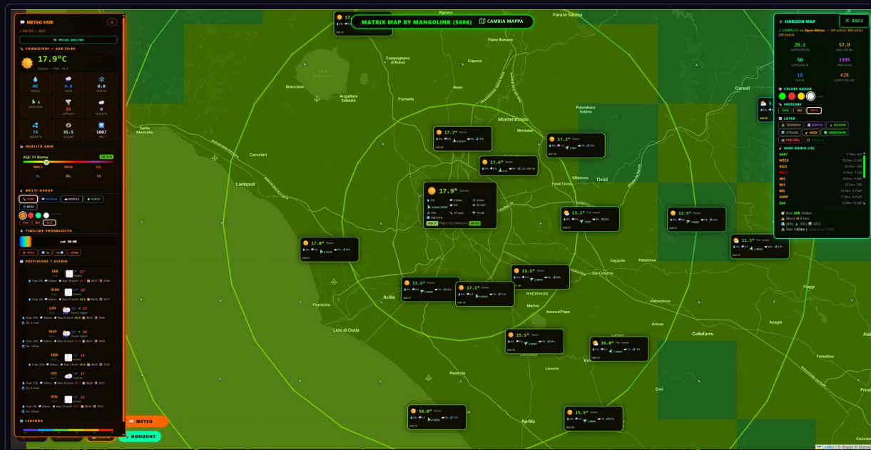
METEO Mode attivo — Ogni nodo mostra una card con temperatura (17.9°, 17.7°, 15.5°...), condizioni (Sereno), vento, umidità, AQI. 18 nodi radio nella lista. Sistema anti-sovrapposizione con angolo aureo.
