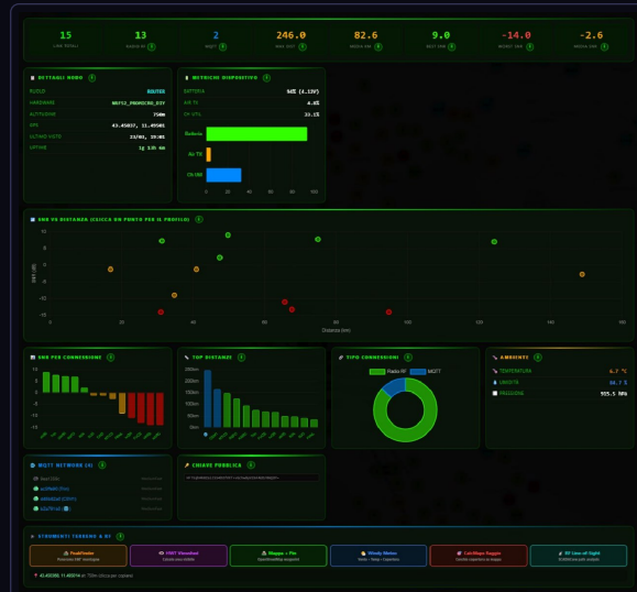
Dashboard completa di un nodo Router a 750m di altitudine — Statistiche rapide in alto, dettagli nodo, metriche dispositivo, grafici interattivi e strumenti RF.
