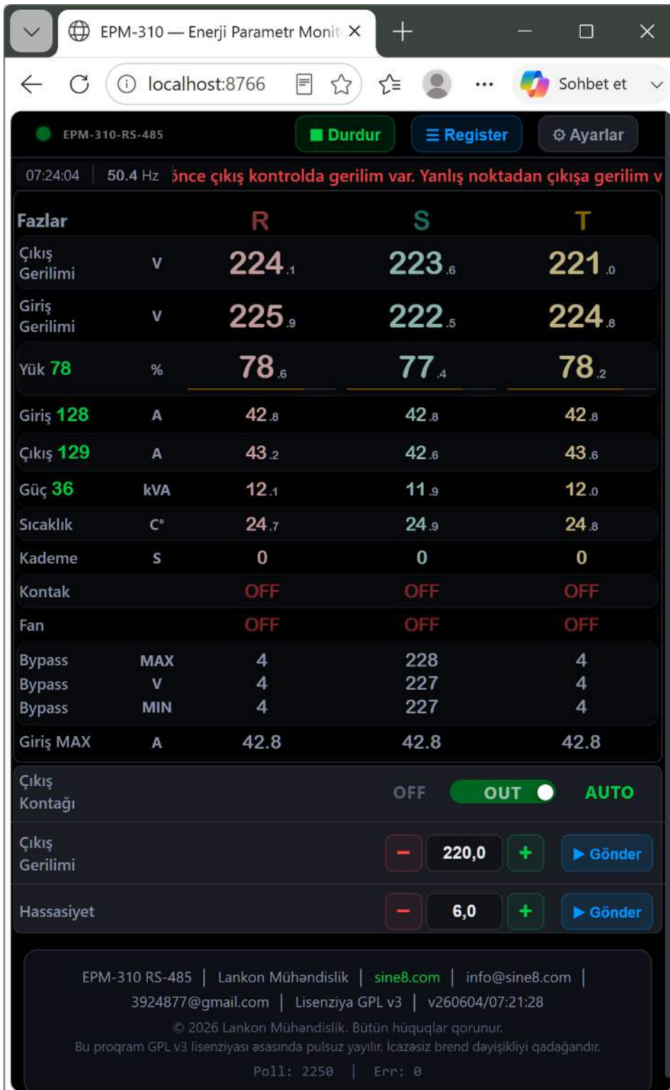
Fig. 5 — Panneau de surveillance — paramètres électriques de phase R, S, T temps réel
