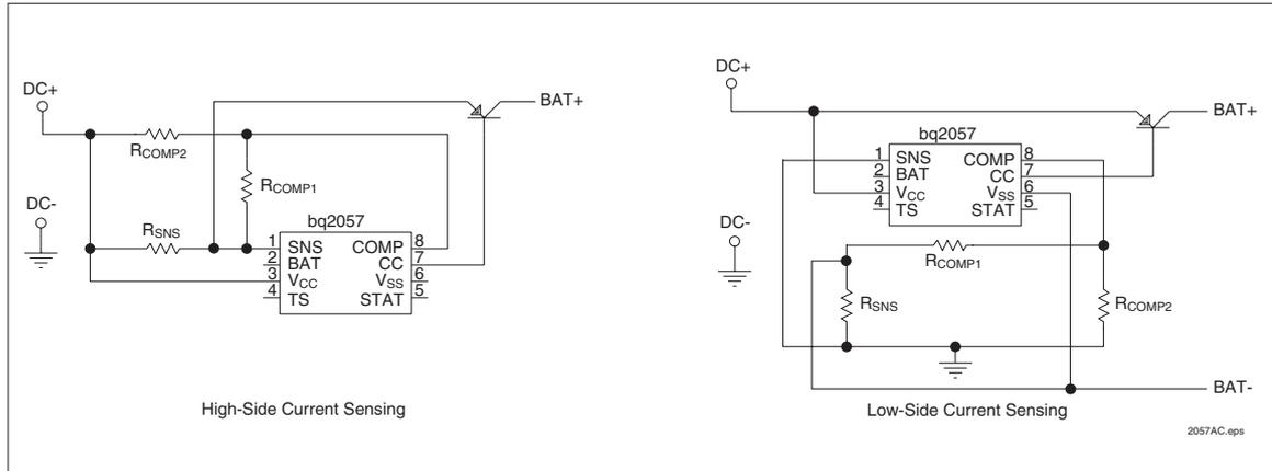
**Figure 12. AutoComp Circuits**
