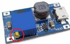
Figura 6- Ajustar a tensão de saída do conversor DC/DC.
