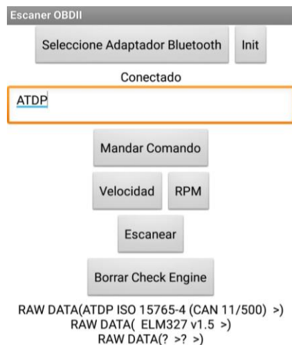
Figura 6 – Aplicativo debug com resposta ao comando “AT DP”.
