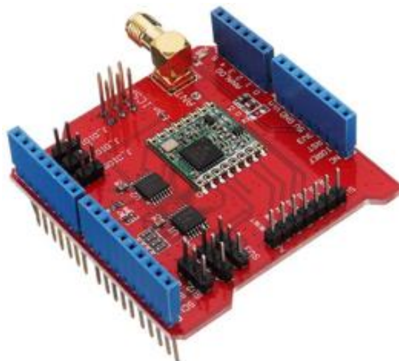
Figura 11 – Dragino LoRa Shield
