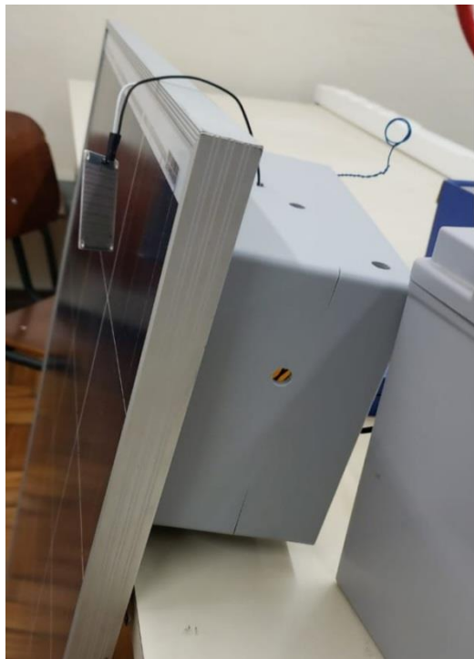
Figura 7 – Invólucro alojado atrás do painel solar
