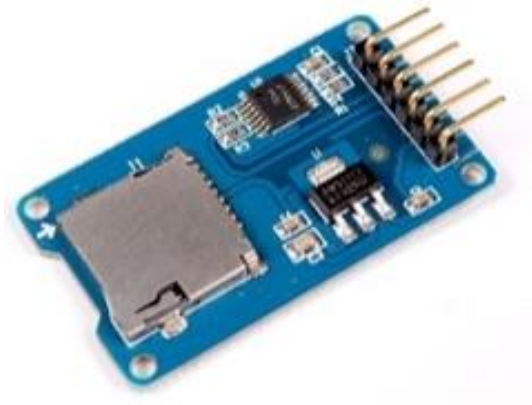
Figura 13 – Módulo SD Card
