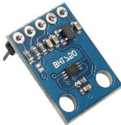
Figura 19 – Sensor de Luminosidade BH1750FVI
