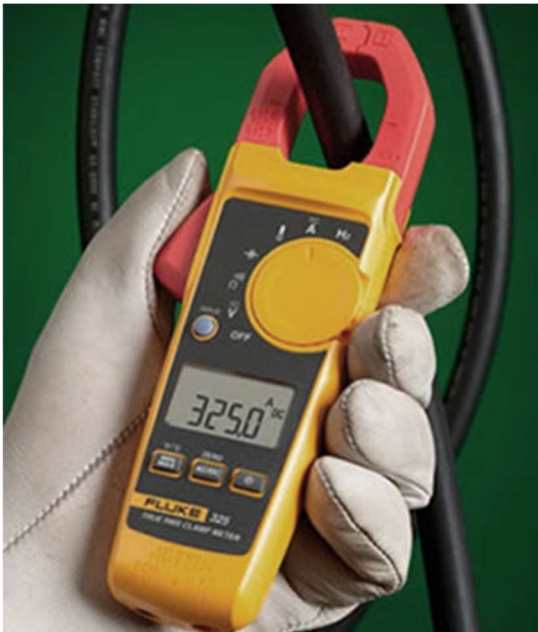
FIGURA 7 – MEDIÇÃO DE CORRENTE ELÉTRICA
