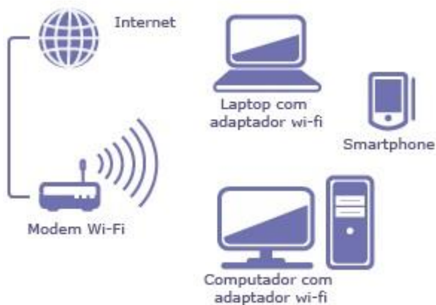
Figura 44 – Funcionamento do sistema wi-fi
