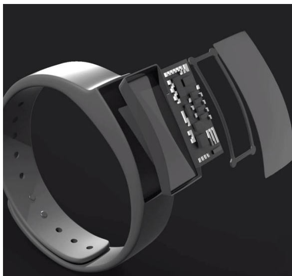
Figura 92 – Componentes eletrônicos da pulseira
