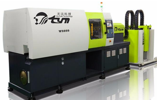
Figura 93 – Injetora de silicone para pulseira e outros objetos
