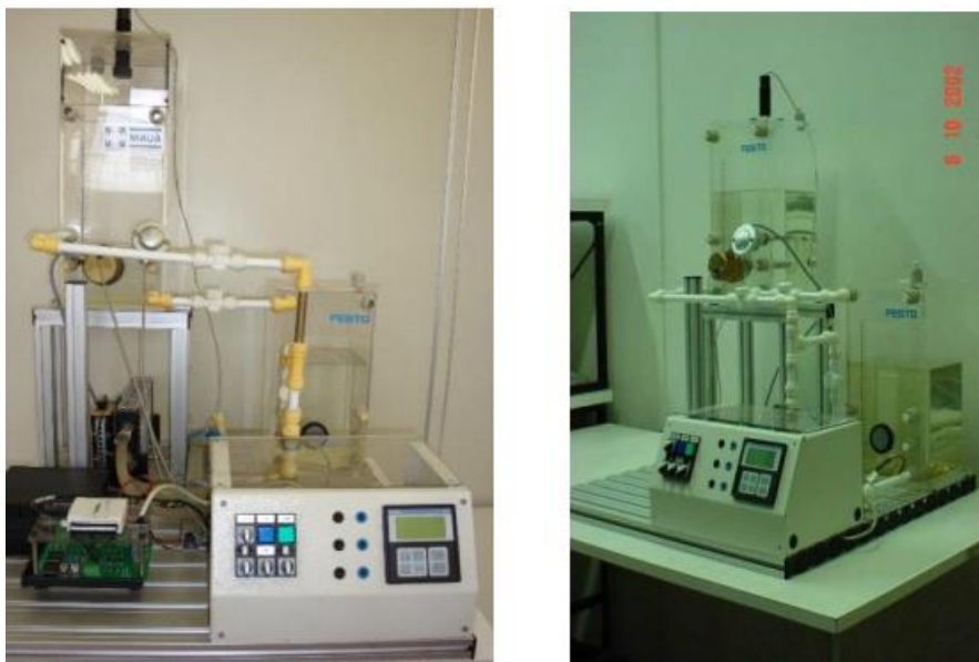
Figura 3 - Planta de controle de nível PCS Festo
