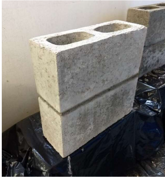
Figura 25 – Assentamento dos blocos de concreto para os protótipos.
