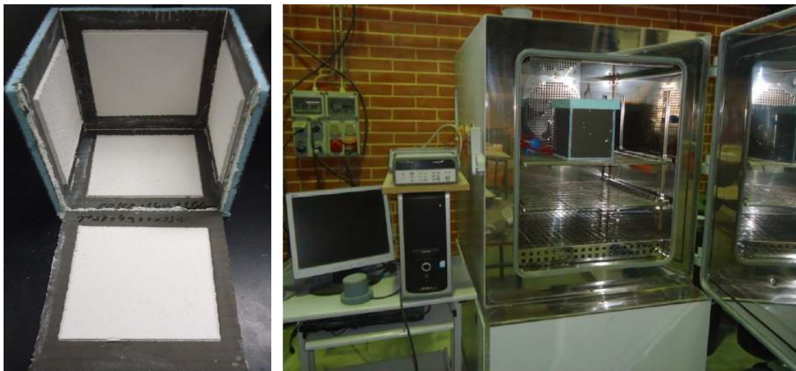
Figura 21 – Protótipo com placas de poliestireno.
