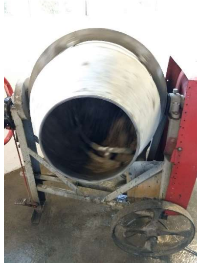
Figura 26 – Execução da argamassa de referência na betoneira mecânica.
