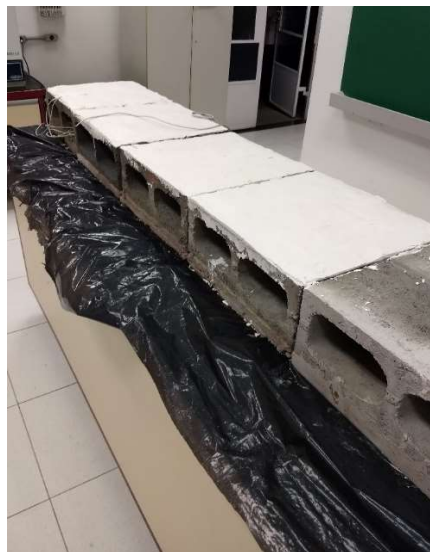
Figura 35 – Revestimento dos blocos com gesso liso.
