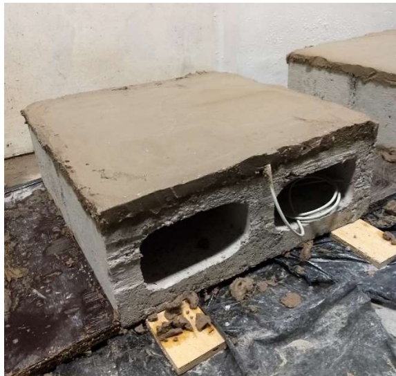
Figura 28 – Revestimento de 3cm da argamassa no estado fresco e seu respectivo sensor de medição de temperatura.
