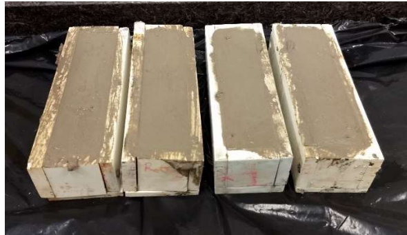
Figura 33 – Moldes dos corpos de prova prismáticos.
