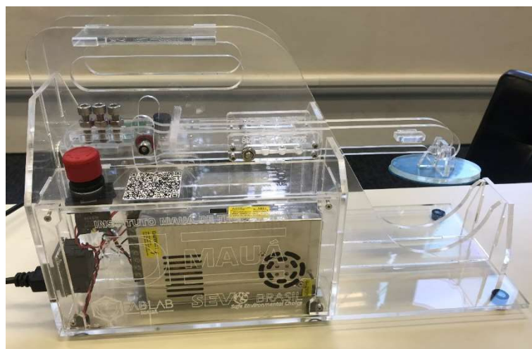
Figura 2 — Ventilador Mecânico desenvolvido pelo IMT
