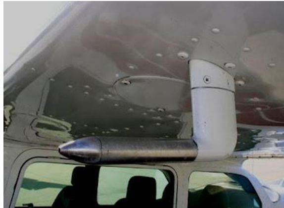
Figura 14 – Exemplo de tubo de pitot de um avião
