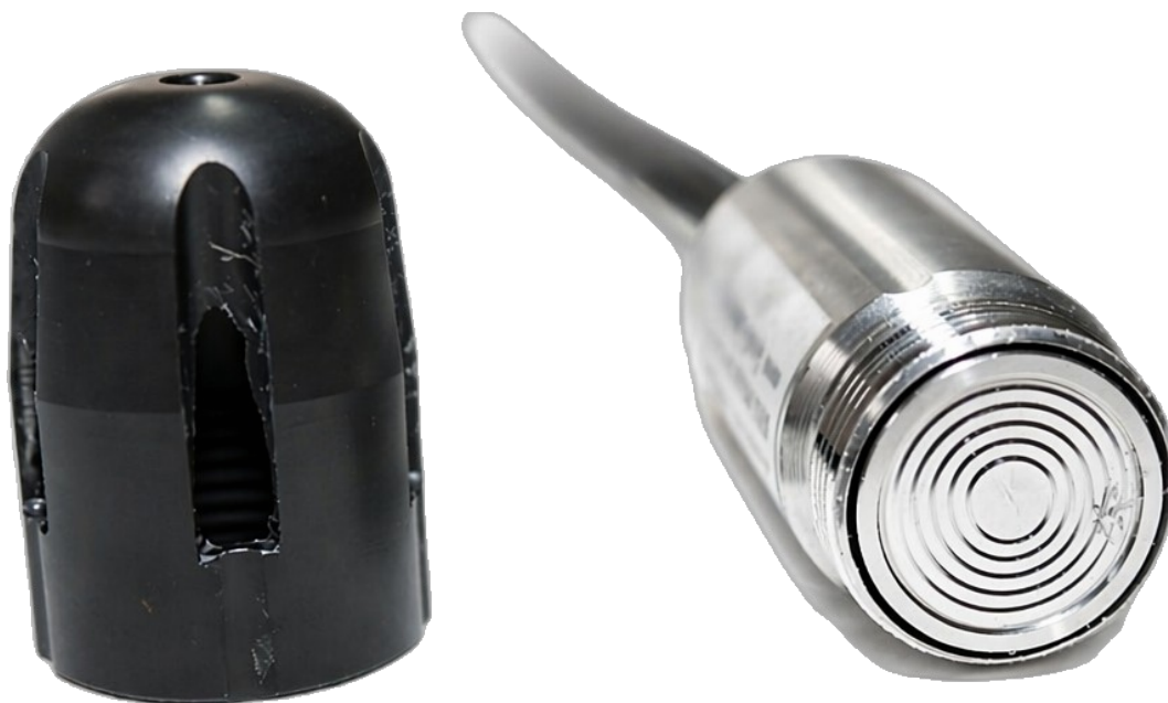
Abbildung 3: Piezo-Drucksensor — laserverschweißte Edelstahl-Messzelle mit abnehmbarem Sensorkäfig. Die ölbefüllte Zelle ist hermetisch gekapselt.
