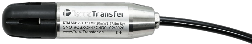
Abbildung 2: Piezo-Drucksensor mit Seriennummern-Gravur. Standardmäßig mit Relativdruck-Kapillare und offenen Litzen für die Verdrahtung an den Wago-Klemmen des AquatOS mini.
