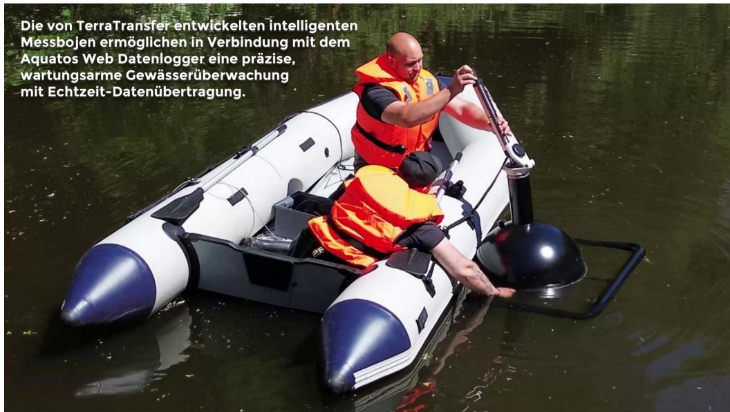
Abbildung 6: Ausbringung der Flachwasserboje vom Schlauchboot — Schwimmwesten sind Pflicht.
