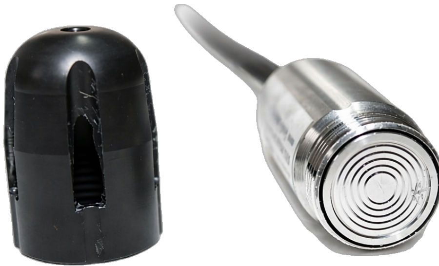
Afbeelding 3: Piëzo-druksensor type 0312 — lasergelaste roestvrijstalen meetcel met afneembare sensorkorf. De met olie gevulde AISI 316Ti-drukcel is zichtbaar na verwijdering van de korf.
